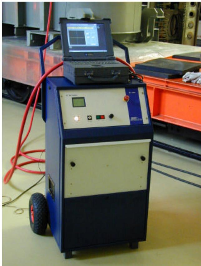
La base para la medición de  $C$  y  $\tan \delta$  con el digitalizador (DSP) se halla en el avanzado y muy conocido sistema de medida LDV-5 para medir la capacidad y factor de disipación. Con la adición de algunos componentes, tales como una fuente resonante hasta 12 kV, un condensador patrón, el juego de cables necesarios y una carretilla de transporte, se pueden realizar también ensayos automáticos de aislamientos en campo.
