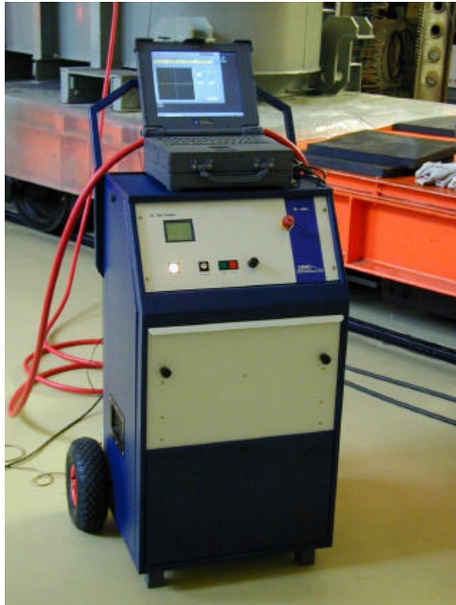
Das Meßprinzip des DSP-gestützten  $C / \tan \delta$  Prüfsystems LDV-5/E basiert auf dem fortgeschrittenen Kapazitäts- und Verlustfaktormeßsystem LDV-5. Es ist erweitert um zusätzliche Komponenten zur automatischen Isolationsprüfung, z.B. einer 20 kV Resonanzanlage, einem Normkondensator sowie den notwendigen Verbindungskabeln und einem Transportwagen.
