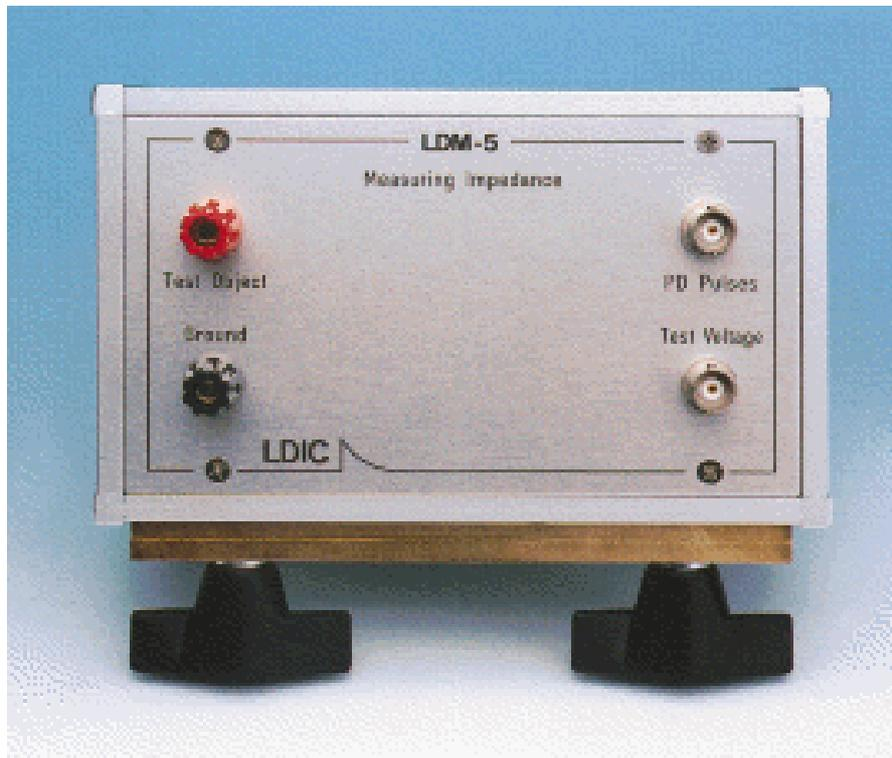
Die Meßimpedanz LDM-5 ist Bestandteil der TE-Meßsysteme von LDIC. Die Hauptfunktion besteht in der Wandlung von TE-Stromimpulsen in äquivalente Spannungsimpulse im standardisierten TE-Meßkreis gemäß VDE 0434 bzw. IEC 60270.
